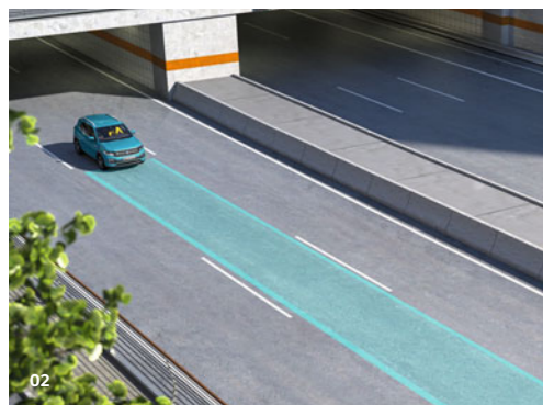
02 Der Spurhalteassistent „Lane Assist“ kann ab einer Geschwindigkeit von 60 km/h erkennen, ob das Fahrzeug unbeabsichtigt die eigene Fahrbahn verlässt. 1) Mit einer korrigierenden Lenkunterstützung kann er die Aufmerksamkeit des Fahrers zurück auf das Fahrgeschehen richten. 1), 2) S
