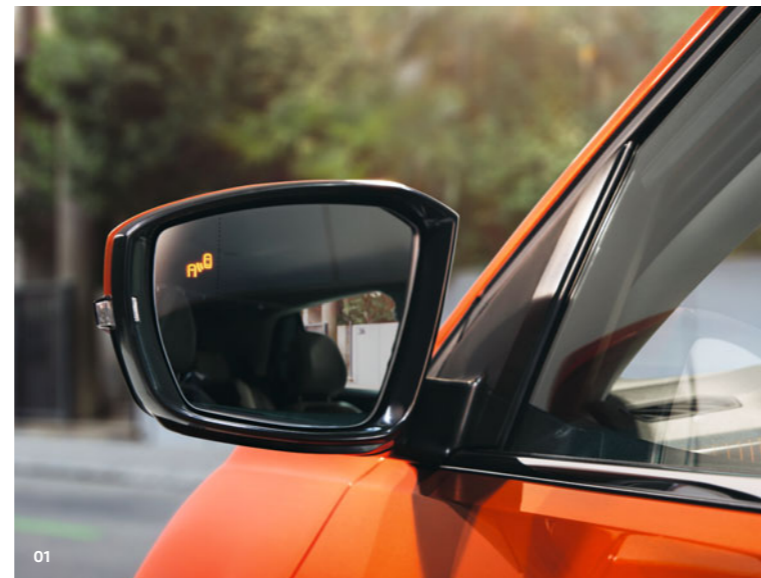
01 Während der Fahrt kann Sie der „Blind Spot“-Sensor über LEDs im jeweiligen Außenspiegel vor Fahrzeugen im toten Winkel warnen. 1) Beim Rückwärtsausparken kann der integrierte Ausparkassistent den Bereich hinter Ihrem Fahrzeug überwachen und Sie so vor erkanntem querendem Verkehr warnen. 1) SO
