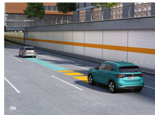
04 Die automatische Distanzregelung ACC kann Ihnen helfen, eine zuvor von Ihnen eingestellte Höchstgeschwindigkeit 3) sowie Abstand zum vorausfahrenden Fahrzeug einzuhalten. 1) SO
