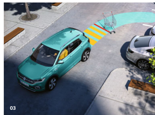
03 Beim Rangieren warnt Sie die Einparkhilfe akustisch und optisch vor erkannten Hindernissen vor und hinter dem Fahrzeug. 1) Die inkludierte Rangierbremsfunktion kann beim Rückwärtsfahren bis zu 10 km/h durch eine Notbremsung eine Kollision vermeiden oder deren Schwere vermindern. 1) Auch beim Vorwärtsfahren können Sie die Rangierbremsfunktion auf Tastendruck aktivieren. LE ST
