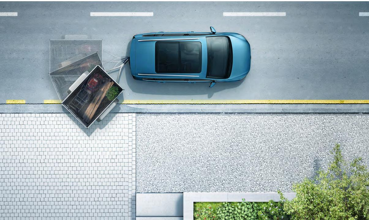
Kaum etwas ist so schwierig, wie mit einem Anhänger rückwärts zu rangieren. Es sei denn, Sie sitzen in einem Touran: Einfach Rückwärtsgang einlegen, Parkschalte betätigen, die gewünschte Fahrtrichtung des Anhängers eingeben, entspannt die Hände vom Lenkrad nehmen und nur noch Gas geben, bremsen und die Umgebung überwachen – den Rest erledigt der optionale „Trailer Assist“.
