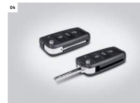
**04 Zentralverriegelung mit zwei Funkfernbedienungen und Innenbetätigung.** Abhängig von der Ausstattung des Fahrzeugs können auch die elektrische Heckklappe und die beiden<sup>6)</sup> elektrischen Schiebetüren über eigene Tasten unabhängig voneinander geöffnet und geschlossen werden. Die Funkfernbedienungen sind über die optional erhältliche Multifunktionsanzeige programmierbar.
