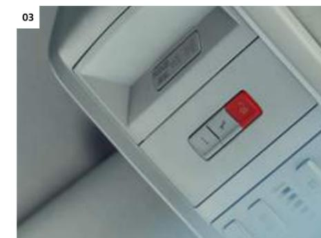
**03 eCall.** Übermittelt nach einem Unfall automatisch Zeit, Position und Anzahl der Insassen an die Notrufzentrale und stellt eine Sprachverbindung her. Aktiviert wird das System durch einen Crash-Sensor oder manuell über die Notruftaste.
