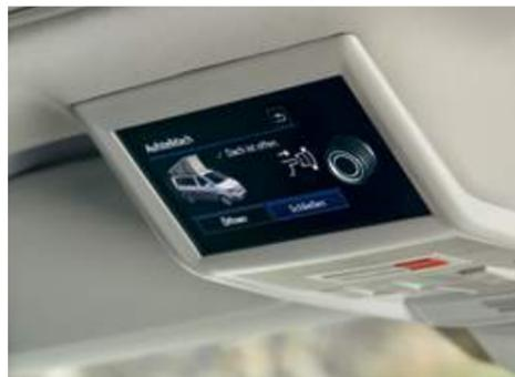
Steuerung des elektrohydraulischen Aufstelldachs<sup>1)</sup>
