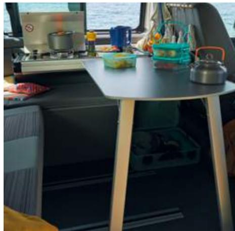
**Miniküche\* mit eingehängtem Klapptisch.** Während der Fahrt sicher in der Schiebetür verstaut, kann der vielseitige Klapptisch bei Bedarf in die Führungsschiene der ausgeklappten Miniküche\* eingehängt und auf zwei Standbeine gestellt werden.
