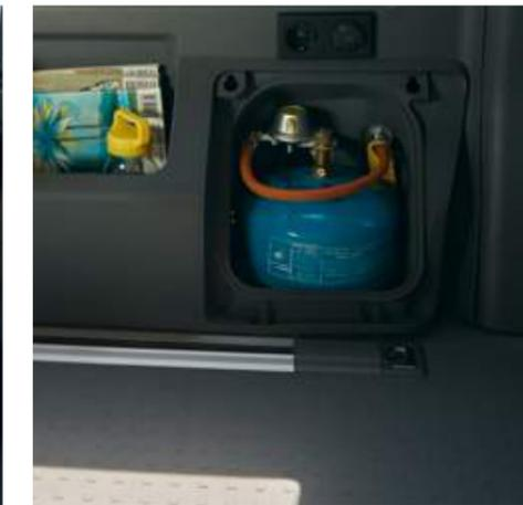
**Gasfach.\*** Unter der hermetisch verschließbaren Abdeckung kann eine optional erhältliche 1,8-kg-Campinggas-Gasflasche an Laschen sicher befestigt und mit dem Gasschlauch verbunden werden.
