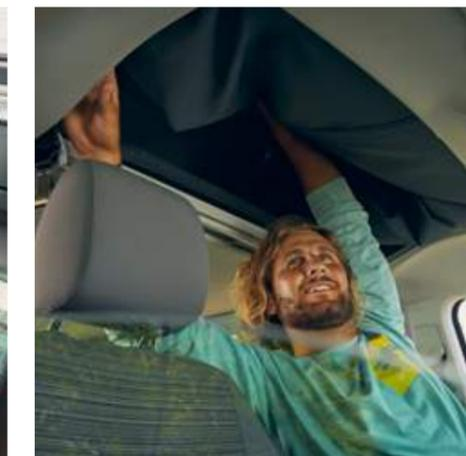
**Manuelles Aufstelldach.** Es lässt sich an der Aufstiegsöffnung leicht entriegeln und nach oben drücken. Auf Wunsch ist der California Beach erstmals auch mit elektrohydraulischem Aufstelldach inklusive Frontöffnung<sup>1)</sup> erhältlich.
