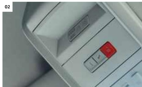
**01 Zentralverriegelung mit zwei Funkfernbedienungen und Innenbetätigung.** Abhängig von der Ausstattung des Fahrzeugs können auch die elektrische Heckklappe und die beiden elektrischen Schiebetüren über eigene Tasten unabhängig voneinander geöffnet und geschlossen werden.
