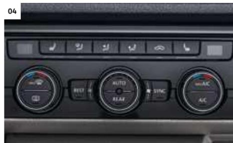
**03 Klimaanlage im Fahrerhaus mit elektronischer Regelung.** Sie ermöglicht es, die Wohlfühltemperatur stufenlos einzustellen.
